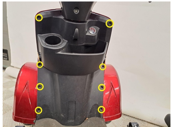
Irrota etukatteen kahdeksan kiinnitysruuvia. (ristipäämeisseli ph2).
