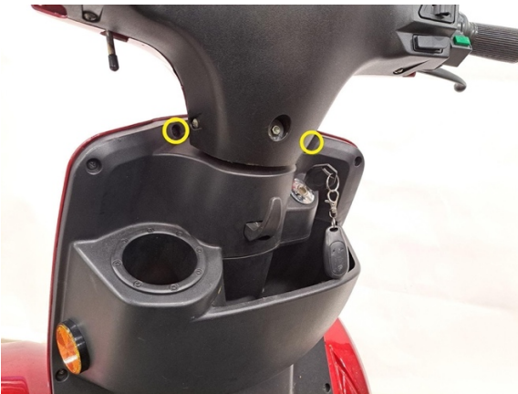
Irrota keulapaneelin kaksi kiinnitysruuvia. (ristipäämeisseli ph2).
